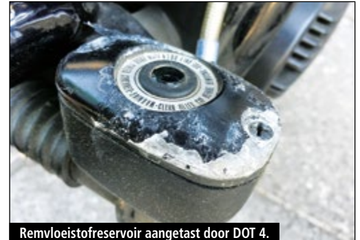
Remvloeistofreservoir aangetast door DOT 4.
