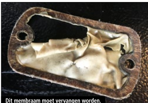
Dit membraam moet vervangen worden.
