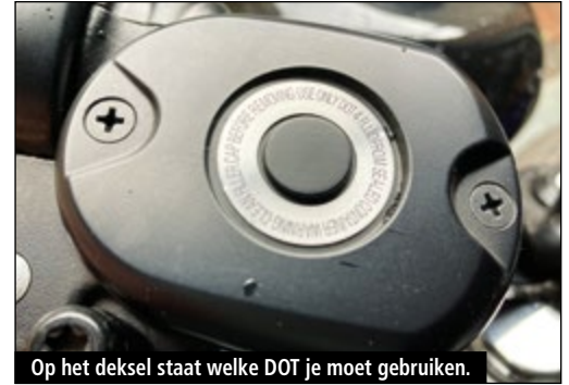
Op het deksel staat welke DOT je moet gebruiken.
