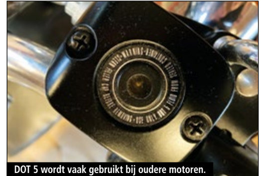
DOT 5 wordt vaak gebruikt bij oudere motoren.
