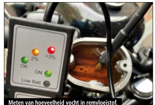
Metten van hoeveelheid vocht in remvloeistof.
